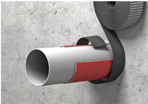
2. Das Metallband durch Abzählen der notwendigen Glieder mit Hilfe eines Befestigungshaken abknicken. Den Haken dabei in das Metallband oben einhängen und darauf achten, dass der Haken auf der linken Seite mit dem Metallband bündig abschließt. Metallband durch Hin- und Herbewegen abbrechen.
